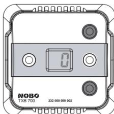
4. Дисплей будет отображать текущую температуру отсчета. Нажатием на кнопки Up-/Down- отрегулируйте необходимое значение температуры.(+/- 6° C).
