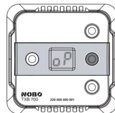
4. Нажатием на кнопки "Up-/Down" включите функцию блокировки (LC) или выключите функцию блокировки (oP).
