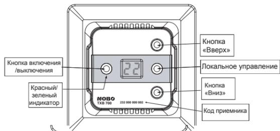
TXB 700 предназначен для использования в качестве центрального комнатного термостата в помещениях с одним и более конвекторов NOBO с R80 TXF или конвекторов со стеклянной панелью Safir. Термостат объединяет до 10 конвекторов, находящихся в одном помещении, в контур управления по радиосвязи.
